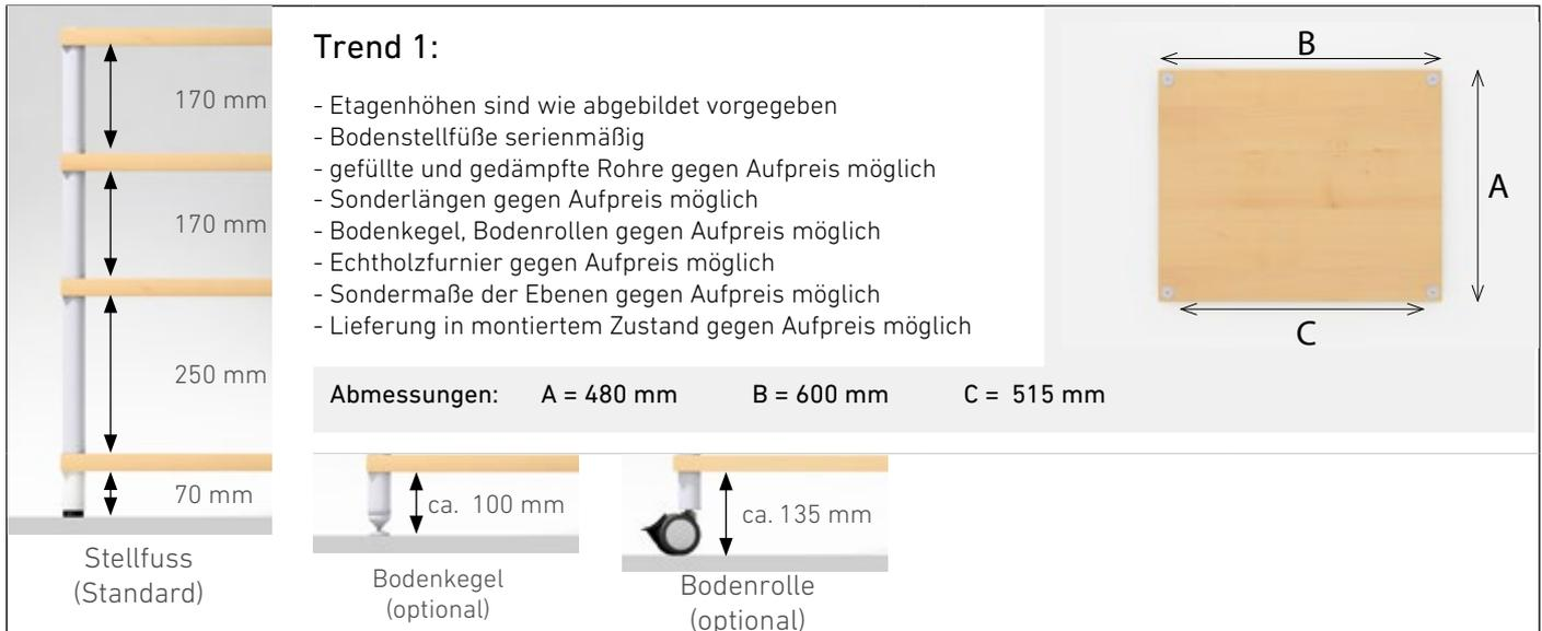
**Abmessungen:** A = 480 mm    B = 600 mm    C = 515 mm
