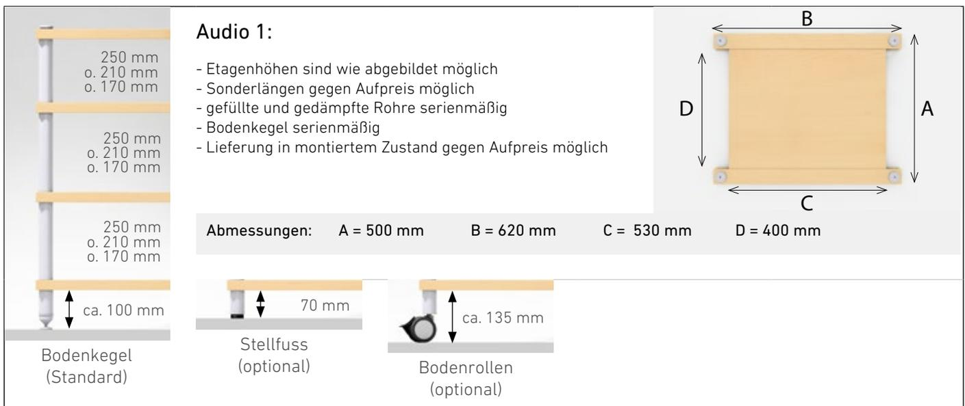
**Abmessungen:** A = 500 mm    B = 620 mm    C = 530 mm    D = 400 mm
